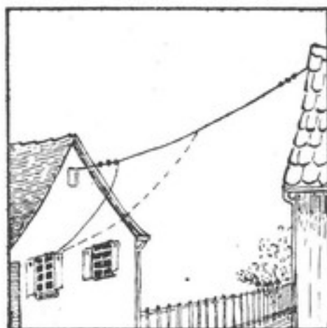
Eindrätige L-Antenne. Die gestrichelte Linie stellt eine T-Antenne dar.
